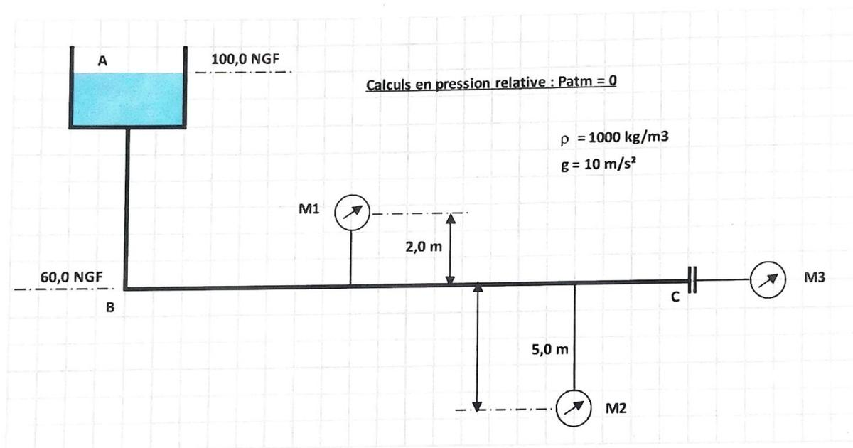
Où M1, M2 & M3 sont des manomètres gradués en bar. Le tronçon de conduite BC est horizontal et à l'altitude 60,0 NGF.
