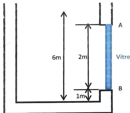
Il est rempli d'eau à une hauteur  $H = 6\text{m}$ , et équipé d'une partie vitrée de forme rectangulaire de dimensions  $(2\text{m} \times 3\text{m})$  qui permet de visualiser l'intérieur.
